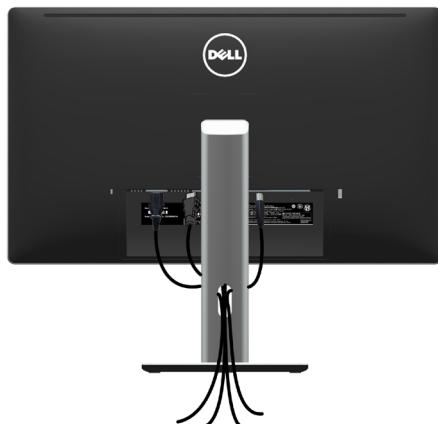
Sau khi kết nối tất cả các loại cáp cần thiết với màn hình và máy tính, (xem [Kết nối màn hình](#) cho phụ kiện cáp), hãy sắp xếp tất cả loại cáp như trình bày ở trên.
